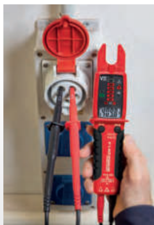
spanningsmeting en draaiveldrichtingstest
